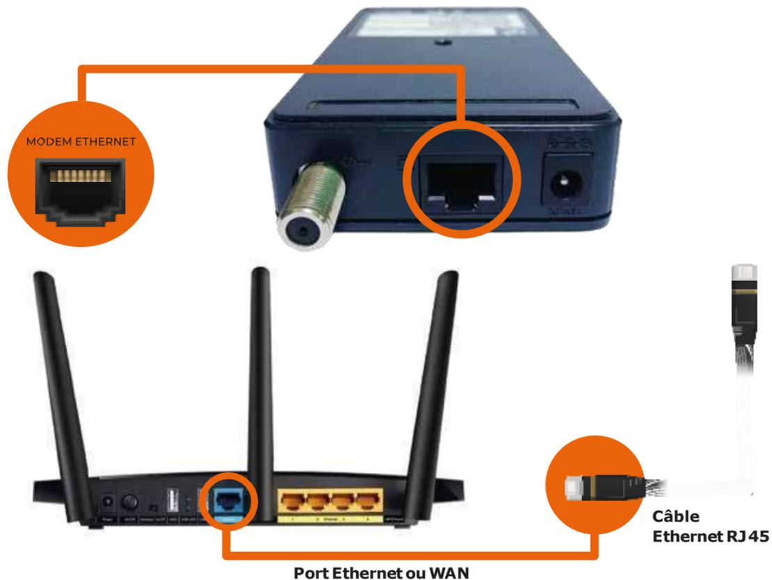
Vous pouvez utiliser le câble Ethernet Rj45 inclus pour connecter votre routeur TP-LINK AC1750 Dans le port Ethernet Ou Wan.
