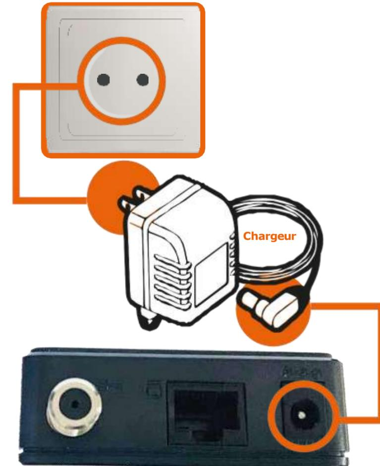
Connectez le câble d'alimentation du modem à une prise électrique.
